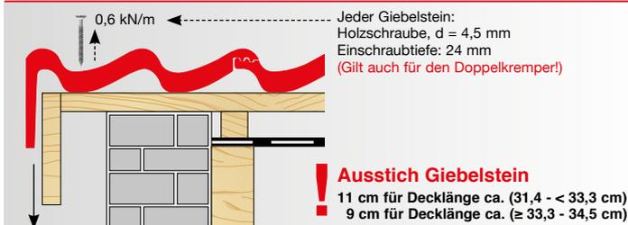
Der Abstand zwischen Innenkante Ortganglappen zur Außenkante Giebelwand bzw. Außenkante Bekleidung oder Unterkonstruktion, muss mindestens 1 cm betragen. (Der Überstand von Doppelkremplern oder Flächensteinen über Außenkante Giebelwand bzw. Außenkante Bekleidung oder Unterkonstruktion muss mind. 3 cm betragen.)
