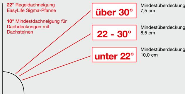
Die Ausbildung der Dachsteine ermöglicht eine variable Höhenüberdeckung. Maßgebend für die Überdeckung ist die Dachneigung. Für Dachsteine mit hochliegendem Längsfalz gelten die nebenstehenden Richtwerte für die Mindesthöhenüberdeckung.
