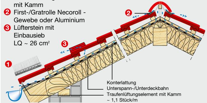
Die genannten Lüftungsquerschnitte haben sich in der Praxis bewährt und werden lt. Fachregeln für Dachdeckungen empfohlen. (in Anlehnung DIN 4108-3)
